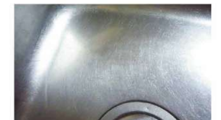
不銹鋼表面刷洗後，刮傷痕跡明顯，無法復原。
