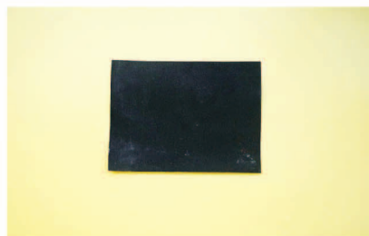
水砂紙 若有細微刮傷及割傷，可直接使用240~400#的水砂紙研磨清除。
